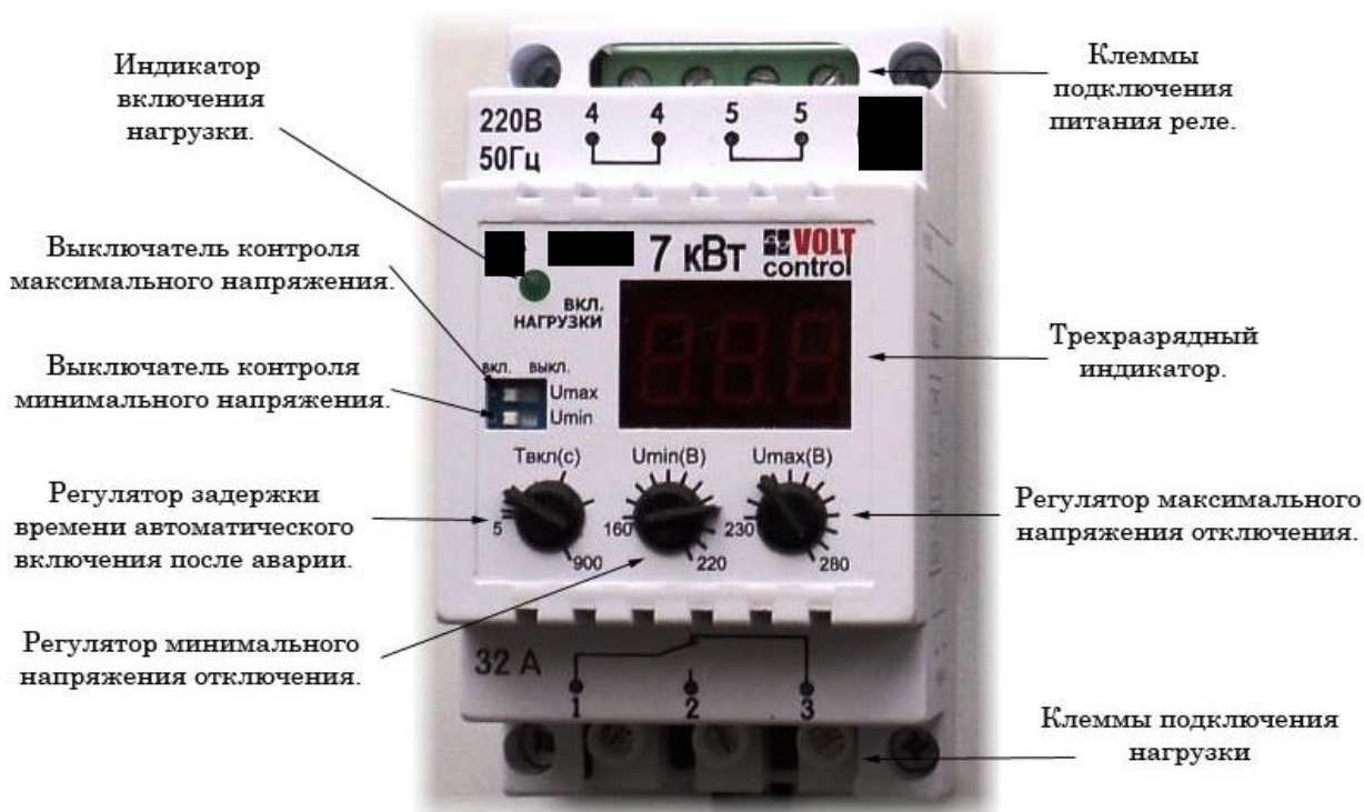
Рисунок 12. Пример маркировки устройства защиты от перенапряжения (реле напряжения)
